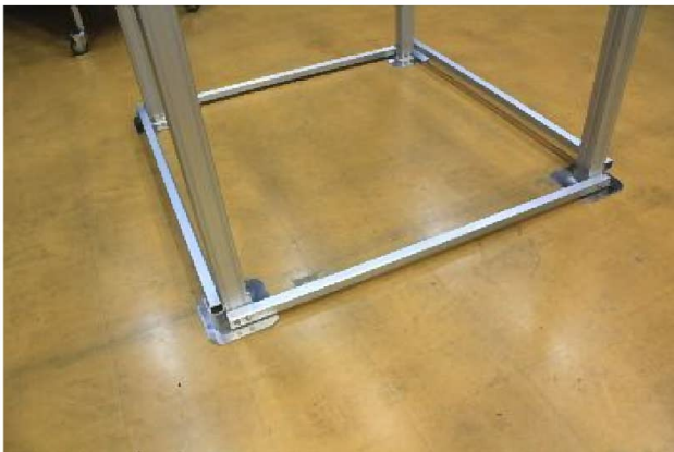
柱開き止めフレーム組立完成写真
