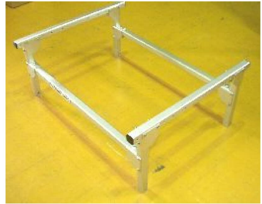
四方に並べたフットパイプの上端のジョイントブラケットAにデッキフレームをトラスM6類で固定します。
