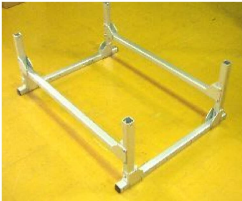
組み上がったフレームをひっくり返しにしてゴムキャップを付けたフットパイプインナーをフットパイプアウターに差込みトラスM8-50類で固定します。
