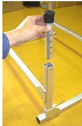
組み上がったフレームをひっくり返しにしてゴムキャップを付けたフットパイプインナーをフットパイプアウターに差込みトラスM8-50類で固定します。
