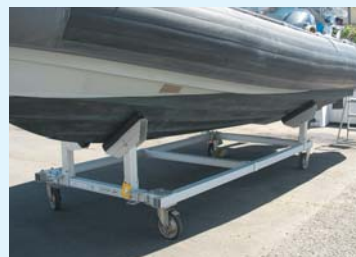
8年前に鉄の台車からアルミに変更されました。今ではフレームはメンテナンスフリーです。
