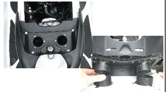
取っ手を外し、蛇腹を外します。
