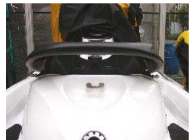
蛇腹を付け、取っ手を艇体へ取付け結束バンドとタンクを付けて完了
