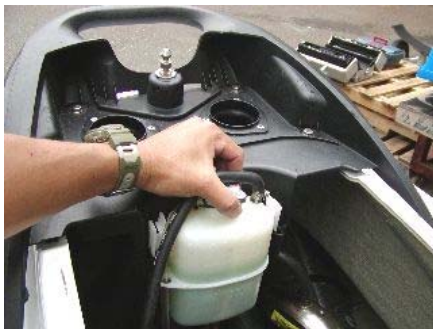
クーラントタンクを外します。
