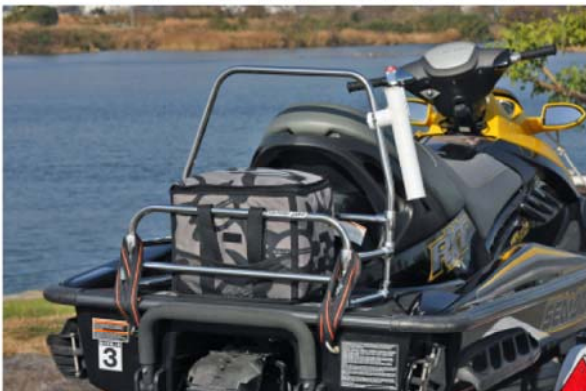
艇体のトランサム部にある左右のUボルトに写真のように カムベルトで左右しっかりと固定します。 ラック側のベルト位置は上側の連結フレームパイプに通します。
