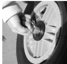
⑰タイヤを③車軸シャフトに入れ、⑬Dリングを写真の様に貫通させて止めます
