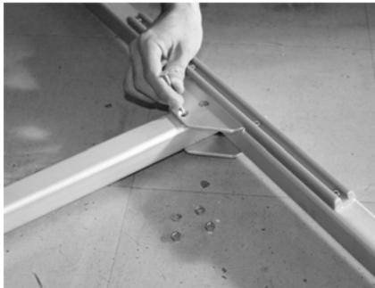
②車軸メインフレームBY-62.63 ハンザ レール付きの中央部ブラケットに①中央パイプ ハンザを入れて⑧SUSブラス皿6-55+⑫M6SW+⑪M6Nで固定します
