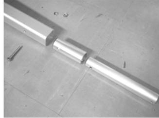
③車軸シャフトと④車軸シャフトカラーを②車軸メインフレームに組み込みます
